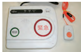
▲緊急通報システム装置およびペンダント
