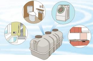
浄化槽は微生物などの働きを利用して生活排水をきれいにする装置です。浄化槽の機能を十分に発揮させるには、定期的な維持管理(保守点検・清掃)と法定検査が必要であり、法律により実施が義務付けられています。適正な維持管理と法定検査を行い、浄化槽を正しく使っていただくよう皆さんのご協力をお願いします。
