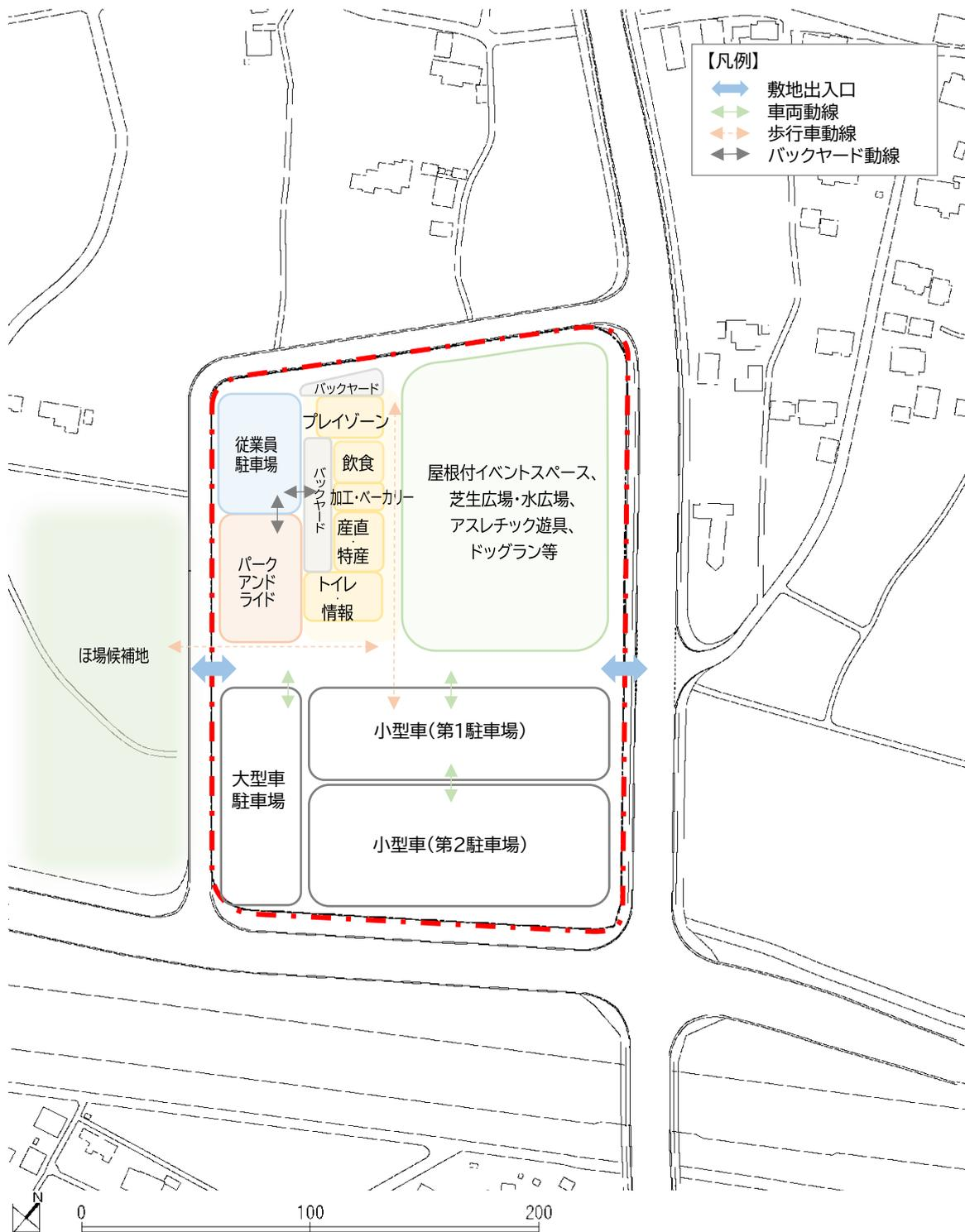
図 4 施設配置イメージ（一棟型）
