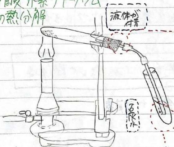
発生した液体が加熱部に流れ、試験管が割れるのを防ぐために口の方を下げる!
