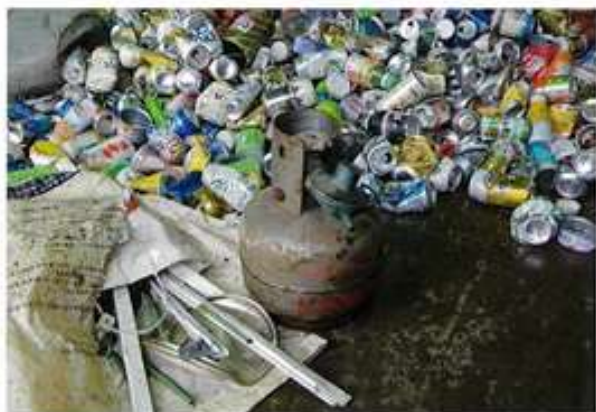
カン類収集物の中にガスボンベが混入されていた
